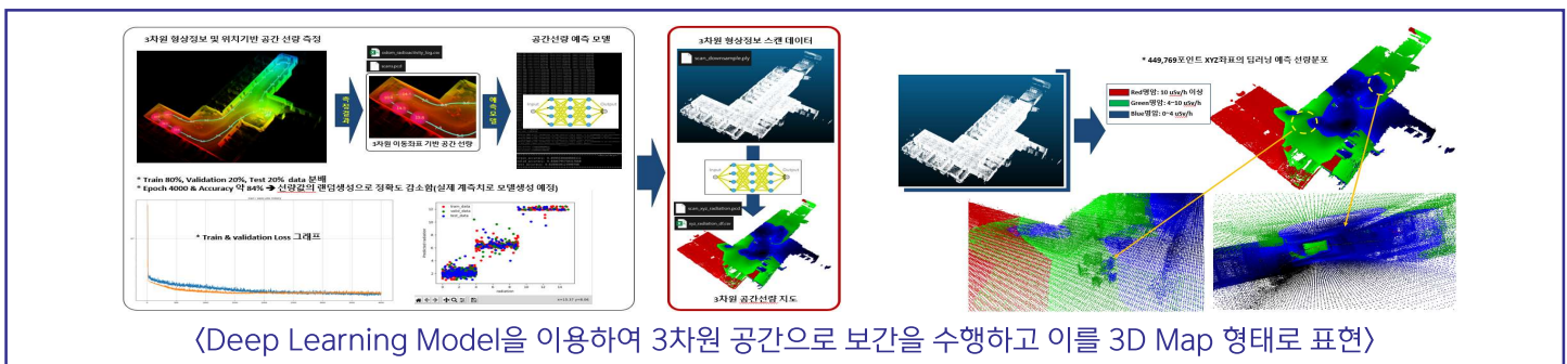
〈이동 방식으로 현장을 측정하여 실시간으로 정합된 3D Point Cloud Data 생성〉
