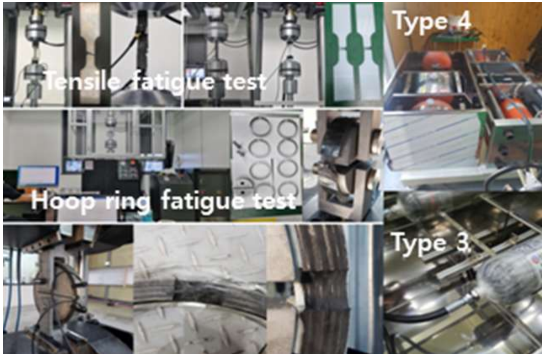
〈용기에 대한 다양한 피로시험 중 AE 데이터 확보〉
