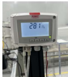
〈필터 성능평가를 위한 측정시스템 구축〉
